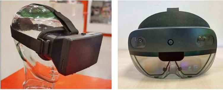
Abb. 3: a) VR-Brille: Nimmt die Sicht vollkommen ein (links), b) AR-Brille: Transparente Gläser mit eingearbeiteten Displays erzeugen den Eindruck, dass sich virtuelle Objekte unmittelbar in der realen Umgebung befinden (rechts)
